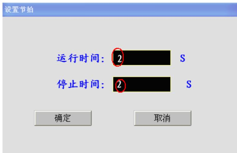
图 16 设置生产线强制节拍时间
